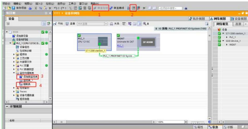
9、打开监视表，查看数据。如下图，强制的输出点接通输出。 QW10,QW14 给 16000 输出，万用表测量电压，电流分别为 5V,10mA。注意模块的配置参照选型手册配置不变。
